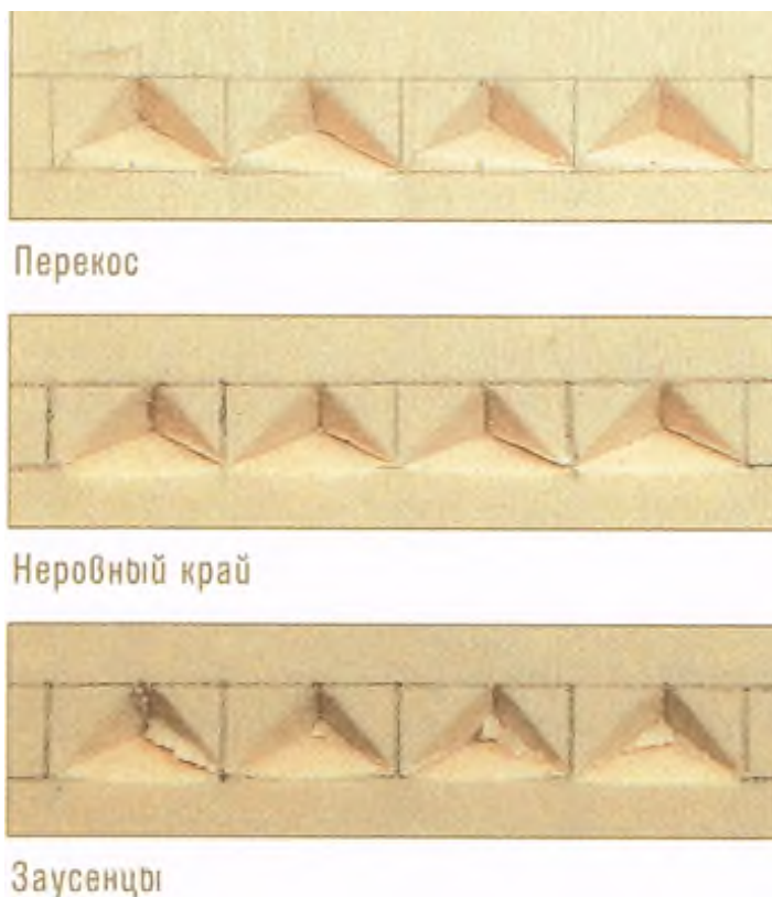
Рисунок 25 - Дефекты при вырезке трехгранных выемок
